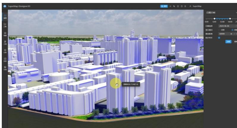
図 3-23 日照シミュレーション機能による指定時間内の日影時間の取得例
