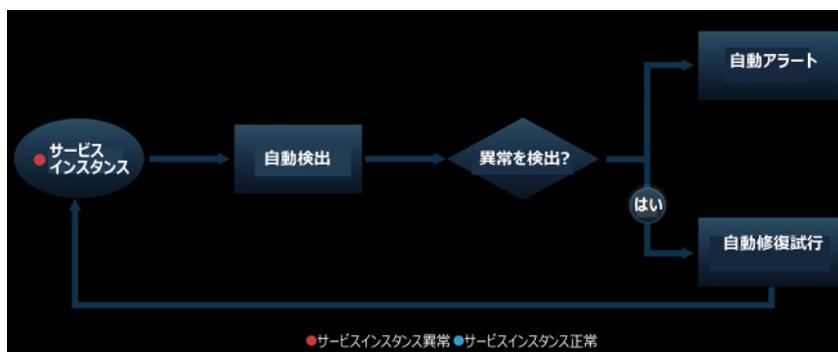
図 4-70 サービスインスタンス自動アラートと修復メカニズム模式図
