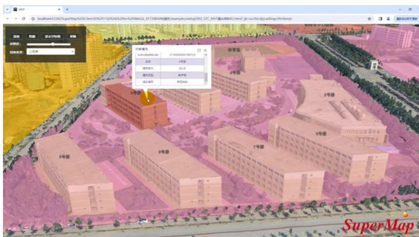
図 7-9 MVT データに基づく写真測量 3D モデルデータの属性クエリ
